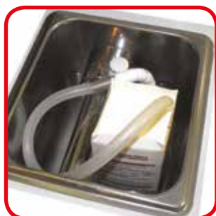
Possibilité de connecter directement la pompe au conteneur de la crème.
