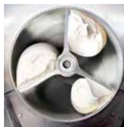
CUVE INFÉRIEURE INDÉPENDANTE À REFROIDISSEMENT CONTRÔLÉ JUSQU'À -10°C
