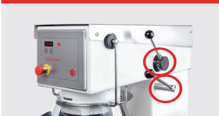
VL1 – Régulation de la vitesse manuelle et abaissement manuel de la cuve
