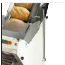
Levier latéral Permet d'engager la coupe du dernier pain en toute sécurité.
