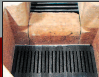
Blocs réfractaires équipant le foyer
